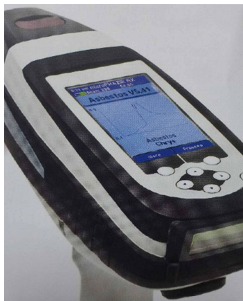
Foto 1. De handheld asbest analyser.
